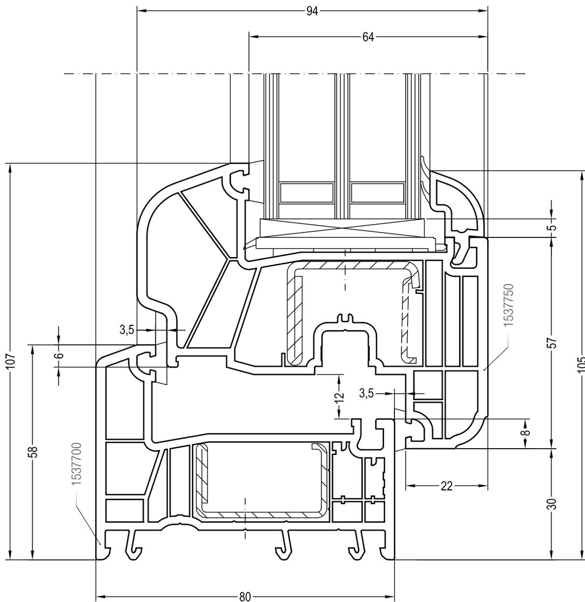
Чертежи узлов окон и балконных дверей
